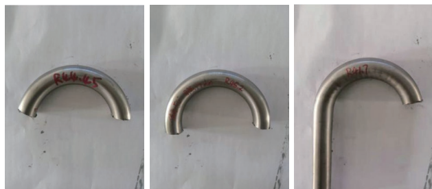
(b) 加装凸轮加工管材
