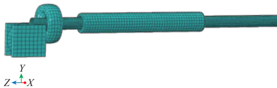
图 3 模型网格划分 Fig.3 Model mesh division
